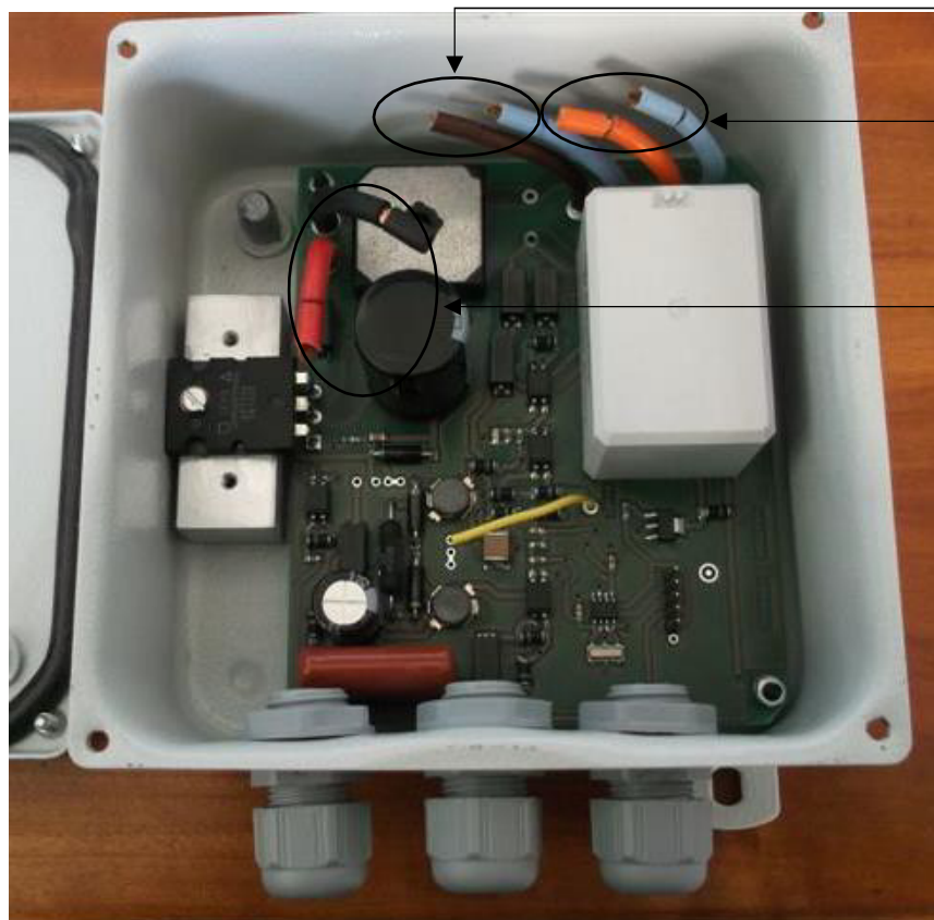
Figura 6 : Interior de la caja de regulación y control
