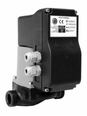
Las Picoturbinas están diseñadas para generar energía eléctrica a partir de un caudal circulante de agua y un diferencial de presión. La energía eléctrica generada es almacenada en una batería, a la cual se le pueden conectar diversas cargas cuyo consumo energético debe ser siempre inferior a la energía producida por la picoturbina. La producción de la Picoturbina puede ser de 600W/dia.
