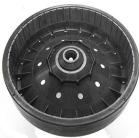
**Imán del rotor:** El rotor (foto izquierda), es la parte móvil y accionado directamente por el rodete de la turbina a través del eje. La Intensidad de campo magnético se puede ajustar para optimizar el número de revoluciones en el caso de los sistemas de carga de baterías directos, utilizando arandelas.
