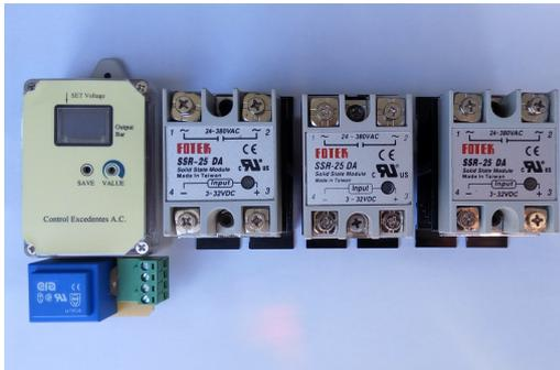
Una variante del regulador DST, es en sistema monofásico Vac o en sistema trifásico Vac (foto izquierda). En este caso el regulador es electrónico, pero la derivación se realiza mediante relés de estado sólido (SSR).
