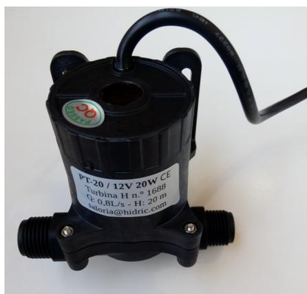
Las Picoturbina está diseñada para generar energía eléctrica a partir de un caudal circulante de agua (0,3-0,8 L/s) y un diferencial de presión (2,0 bar max). La energía eléctrica generada es almacenada en una batería (45Ah max. -no incluida-), a la cual se le pueden conectar diversas cargas cuyo consumo energético debe ser siempre inferior a la energía producida por la picoturbina.
