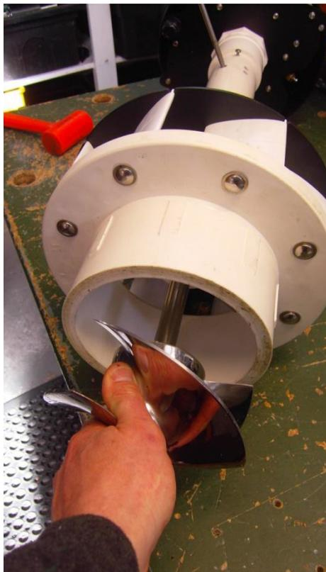
Retire la hélice y el eje de transmisión (foto izquierda). Será necesario tirar y rotar para separarlo del acoplamiento.
