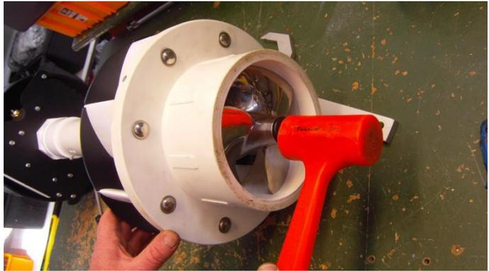
Suba el eje hasta que el borde superior de la hélice toque la barra de corte. Pruebe de hacer girar el eje, para verificar bien su rotación.
