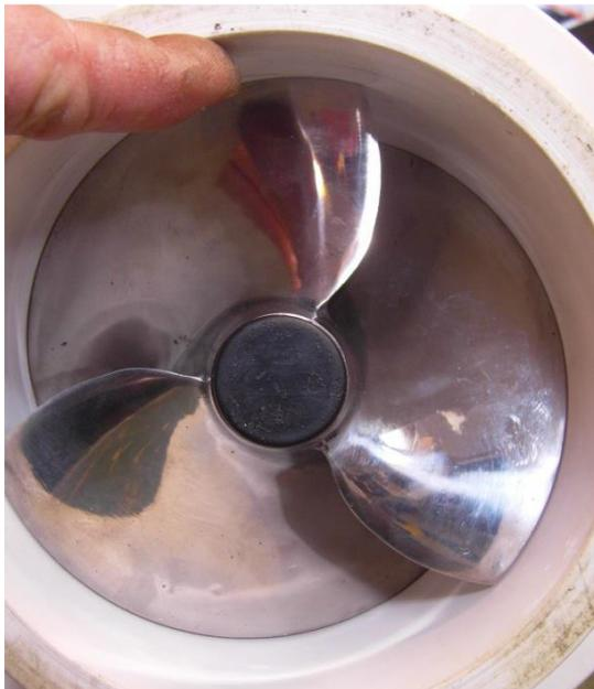
Vea la hélice desde la parte inferior y, si tiene algún roce obvio (por estar un poco descentrado), toque el tubo del eje impulsor (en el accesorio grande) para centrarlo como se muestra a continuación.
