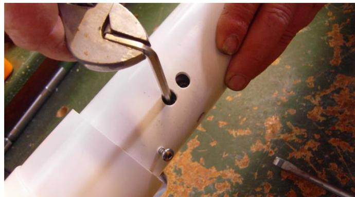
Retire el destornillador y apriete los 2 x tornillos M5 como se muestra. Ponga la cubierta de ajuste en su posición.
