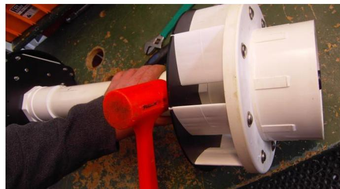
Repita según sea necesario hasta que la hélice esté centrada en la carcasa de PVC y pueda girar. Apretar bien, para que no se afloje al estar en marcha.
