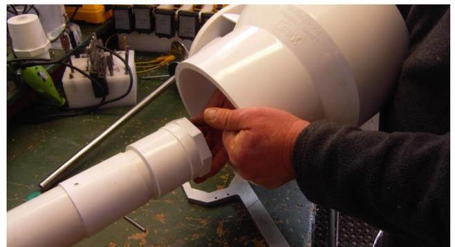
Vuelva a colocar la brida de la paleta, sujetando la tuerca grande como se muestra, apriete girando la brida de la paleta. Tiene que estar muy apretado..
