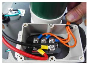
Conecte el cable de CC de salida al rectificador tal
