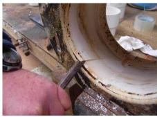
Antes de poner el nuevo, alisar la superficie interior para que se adapte a la hélice. Compruebe también que la hélice ha tenido un desgaste uniforme y que sigue siendo perfectamente redondo. Entonces tendrás un ajuste muy bueno. Consulte la sección siguiente para obtener
