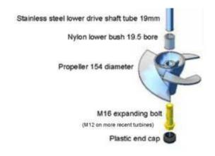
Tenga en cuenta que el rodamiento de nylon blanco (nylon lower) es una pieza de recambio y se debe conservar en un lugar seguro fuera de la luz solar. Sustituya este rodamiento cada año. Hay disponibles casquillos de PTFE mayores a partir de 2015. A partir del 2016 se sirven rodamientos de latón. Compruebe la DO tanto de su casquete como de su perno en expansión cuando haga un pedido para turbinas más antiguas, ya que han sido susceptibles de cambios.
