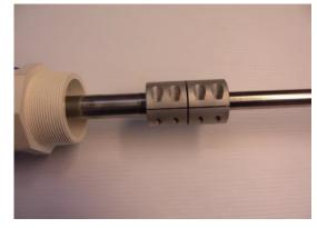
Utilice adhesivo de construcción de poliuretano durante 1 hora o producto similar. Limpiar las superficies que se deben pegar con un paño húmedo limpio para humedecerlas solamente. Aplique el pegamento fina en las dos superficies y púlsela, dejar curar durante la noche. A continuación, mecanizarse como antes y ajuste a su turbina.
