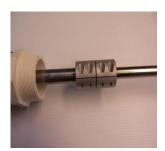
Utilice un destornillador de punta plana para facilitar el ajuste del eje de la hélice. Introduzca el eje de la hélice desde abajo y apriete el acoplador del eje dentro del tubo exterior del eje de 75 mm. Utilice una llave hexagonal de 5 mm metida por los agujeros de acceso y apretarla al par especificado.
