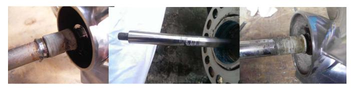
Entre la hélice y la brida fija de PVC, hay un anillo de PVC de 160 mm de diámetro enganchado por el interior de la brida. Para sacar este revestimiento antiguo, cortar longitudinalmente con una sierra en varios lugares y cinceles-lo. Una pistola de calor ayuda.
