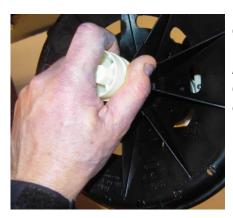
Gire el pomo hasta que los imanes del rotor queden completamente sobre el estator (a menos que hayas puesto arandelas, entonces queda un poco por encima). Apretad sólo con la mano. Gire el rotor con la mano: debería girar libremente. Si no es así, compruebe el cableado, ya que la resistencia se produce a menudo por un cable en un lugar equivocado.
