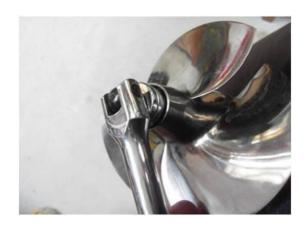
destornillador al final de la fijación en expansión (sólo en unidades anteriores con tornillos M16, los modelos posteriores son M12). Esto es para ayudar a deshacer la reparación en el futuro.
