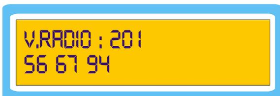
Seguidamente y en el caso de haber configurado válvulas vía radio, aparecerá esta pantalla. Al igual que con las válvulas conectadas por cable al programador, podemos introducir las 96 válvulas que pueden ser controladas por radio.
