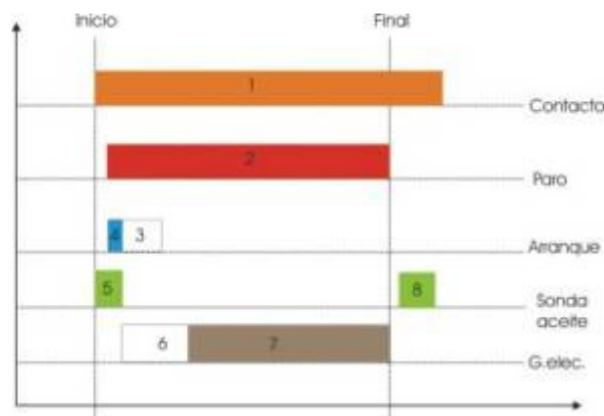
En este gráfico se puede apreciar la maniobra que realizará el programador para poner en marcha y parar el motor.
