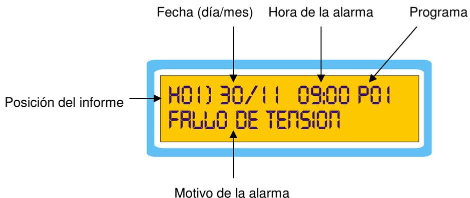
Los diferentes motivos de alarma que se indican en este informe son: fallo de tensión, contador de agua, contador de fertilizantes, alarma por la sonda de aceite o alarma por entrada externa.
