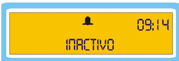
Por defecto el programador no dispone de una programación en memoria y muestra los valores que tiene por defecto y la hora.
