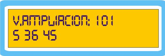
En el caso de disponer de válvulas vía remotas (módulo de ampliación conectado mediante cable al **SIRIUS 90**), aparecerá esta pantalla.
